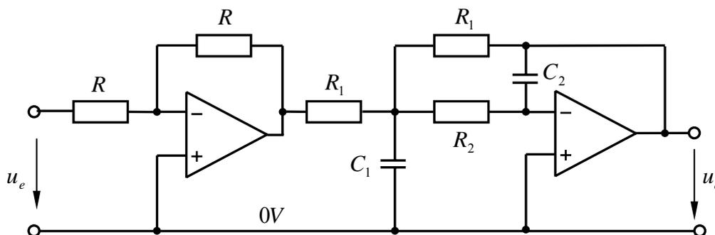
Die Vorzeichenumkehr des zweiten Verstärkers wird durch die Invertierung des ersten Verstärkers aufgehoben. Die gesamte Schaltung (Regelstrecke) besitzt  $PT_2$ -Verhalten.
