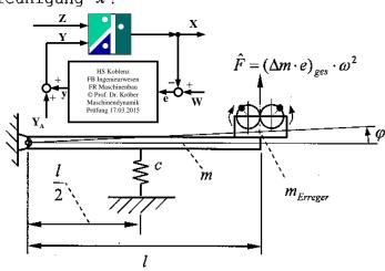
Die Differentialgleichung für das System lautet (kleine Auslenkungen):
