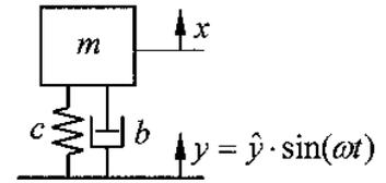
Ferner sind gegeben:  $m = 12 \text{ kg}$ ;  $c = 10^5 \text{ N/m}$ ;  $b = 438 \text{ Ns/m}$
