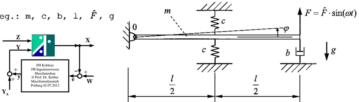
Im Ansatz kann das System durch folgende Differentialgleichung beschrieben werden (kleine Auslenkungen):
