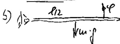
$$J_0 \ddot{\varphi} = \underbrace{A \cdot \sin(\omega t)}_{\text{Kommt hinzu}} - m \cdot g \cdot \frac{l}{2} - b_D \cdot \dot{\varphi} - c_D \cdot \varphi$$
