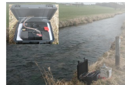
Sensorbox für Wasserqualitätsmonitoring und Messdaten für Mittelwasser / © T. Baumann 2023
