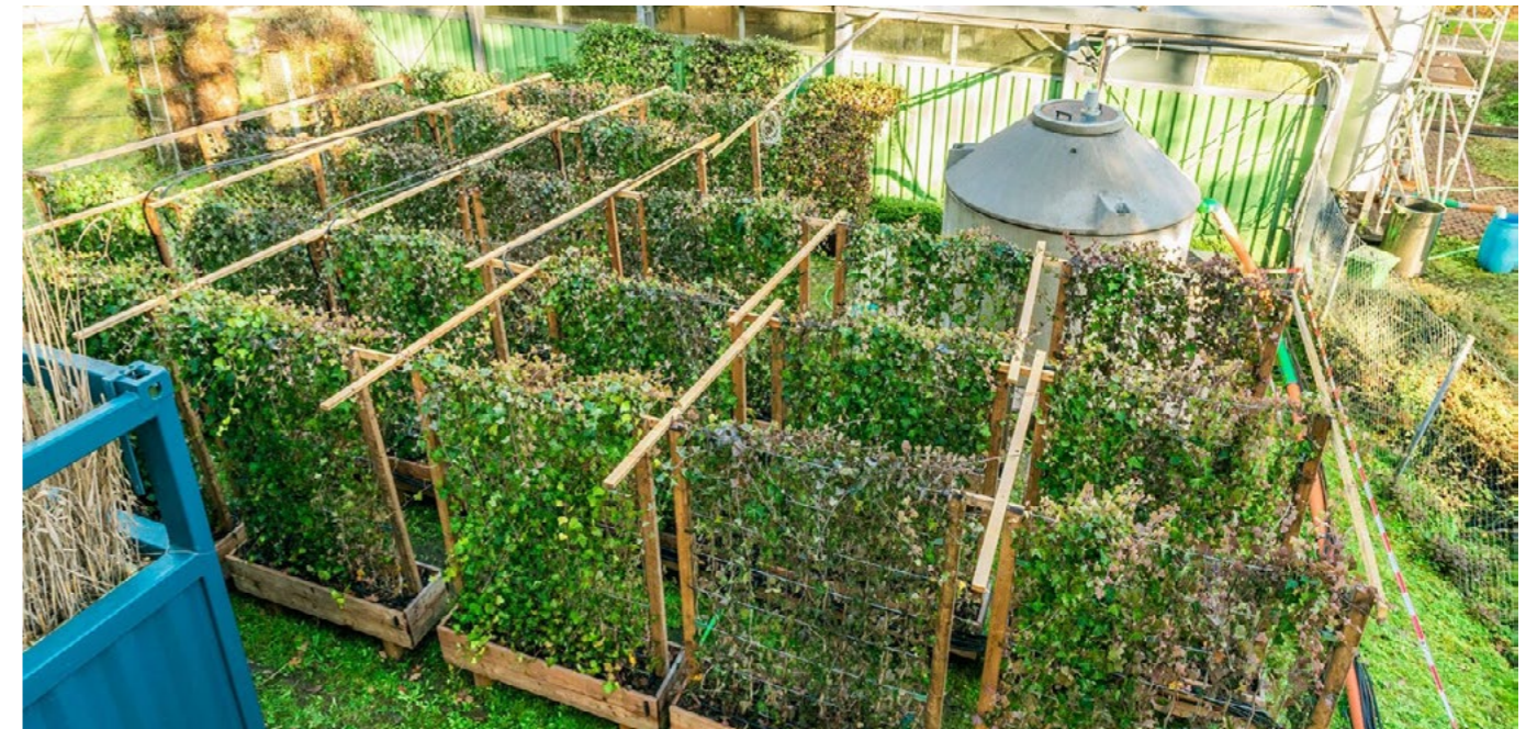
Efeu-Fassadenmodule für Bewässerungsversuche mit unterschiedlichen Niederschlagsabflüssen – Versuchsstand mit Gründach und Betriebswasserspeicher / © E. Rott, ISWA Universität Stuttgart
