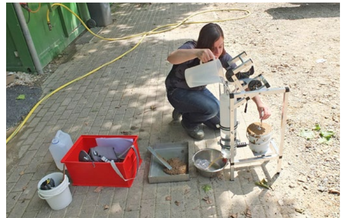
Messung der Fließgrenze unter Baustellenbedingungen
